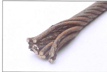
刷毛やスプレーでのグリース塗布は、ロープの表面だけ、頻繁に行わなければならないということで、不十分・高コストそして危険を伴います。グリース補給はロープの寿命を伸ばすことが良く知られていますが、ロープの表面だけに塗布することはあまり効果がありません。水蒸気がグリースによって表面に形成された薄膜を通り抜けて入り込み、ロープ内部に留まります。温度変化により液化すると、薄膜によって閉じ込められてしまい、内部腐食が発生してしまいます。
